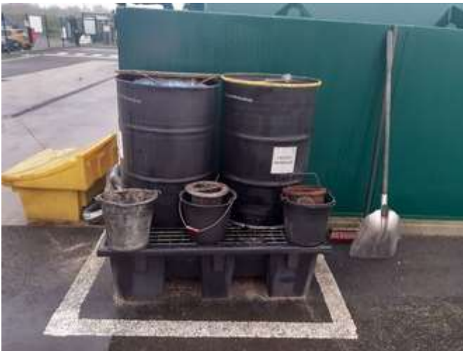
Rétention sur laquelle sont stockés des bidons de chiffons souillés
